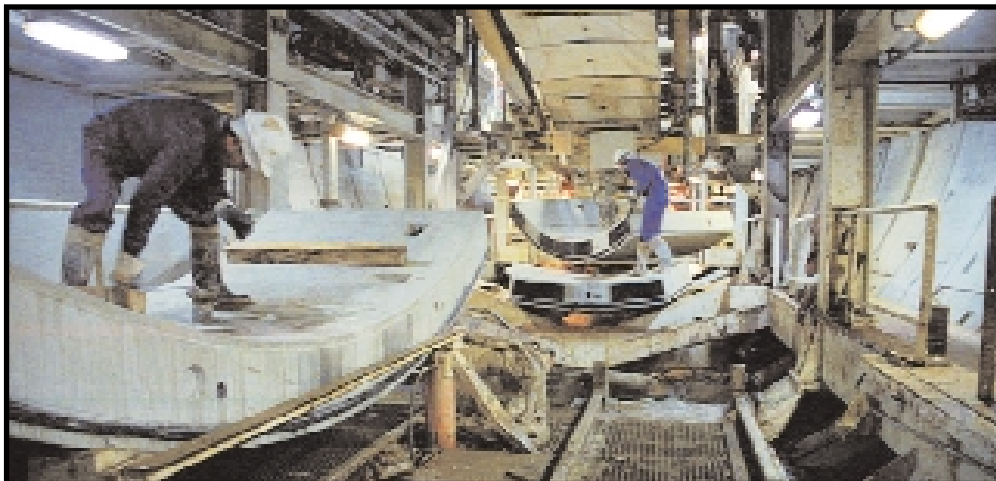
Piezas de hormigón prefabricadas para revestir el túnel.
